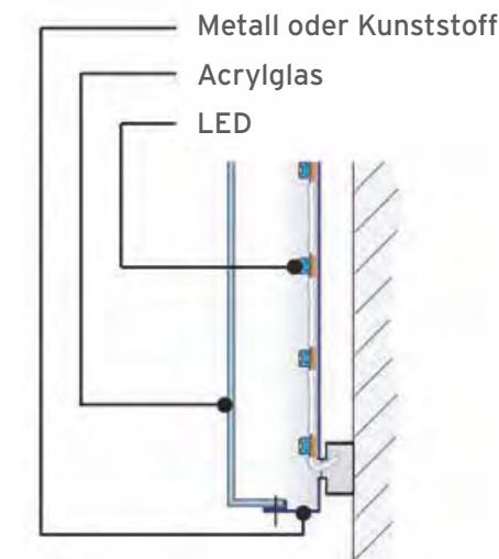
Das **ETS** ist ein einseitig leuchtendes Transparent mit eingeschobenen stehenden oder hängenden Plexiglasscheiben. Der Metallprofilrahmen besitzt eine stabile Alu-Rückwand und ist mit Leuchtstofflampen konfektioniert. Die Bautiefe beträgt mindestens 160 mm, um eine gute Ausleuchtung zu garantieren. In RAL-Farben lackiert lieferbar.
