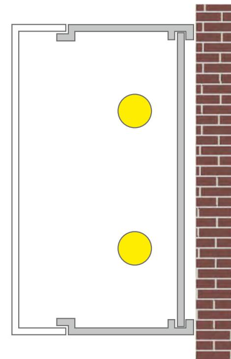
Das **DTS** ist ein doppelseitig leuchtendes Auslegertransparent mit Plexiglasscheiben. Der Metallprofilrahmen ist mit Leuchtstofflampen konfektioniert und mit Wandabstandshaltern bestückt. Die Bautiefe beträgt mindestens 200 mm, um eine gute Ausleuchtung zu garantieren. In RAL-Farben lackiert lieferbar.
