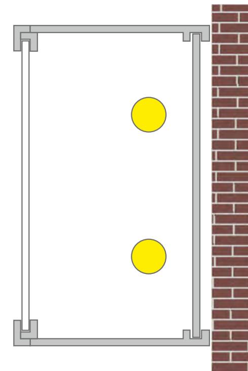
Das **ETH** ist ein einseitig leuchtendes Transparent mit einer aufsteckbaren geklebten transluzenten Plexiglashaube. Der Metallprofilrahmen besitzt eine stabile Alu-Rückwand und ist mit LED-Ausleuchtung konfektioniert. Die Bautiefe beträgt mindestens 160 mm, um eine gute Ausleuchtung zu garantieren. Die beleuchtete Fläche ist größer als bei gleichgroßen ETS Modellen. In RAL-Farben lackiert lieferbar.
